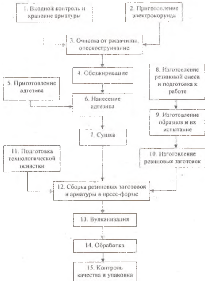
Рис. 1. Технологическая схема изготовления РМИ
